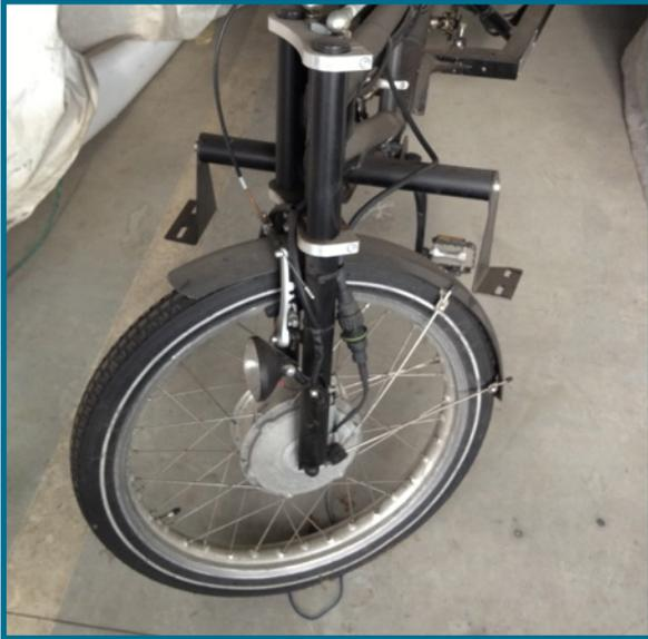
Il motore per la pedalata assistita è alloggiato nel mozzo della ruota anteriore. Come stabilito dalla legge è un motore della potenza nominale di 250W.
