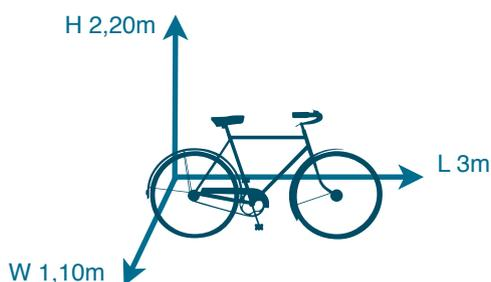
Tenuto conto quindi non solo del codice della strada riguardante i velocipedi, ma anche delle dimensioni delle piste ciclabili e della distanza minima fra i dissuasori del traffico è possibile scegliere come vincolo massimo di larghezza per il triciclo la cifra di 1,10m, di modo che sia in grado di passare dappertutto.
