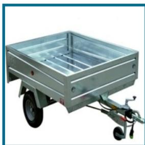
L'ultima parete, quella posteriore, è incernierata al telaio per potersi abbattere, aprendo il vano di carico.
