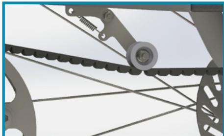
Per mantenere la cinghia tesa in ogni momento è stato posto sul telaio un tendi cinghia composto da una puleggia di teflon e da una piccola molla.
